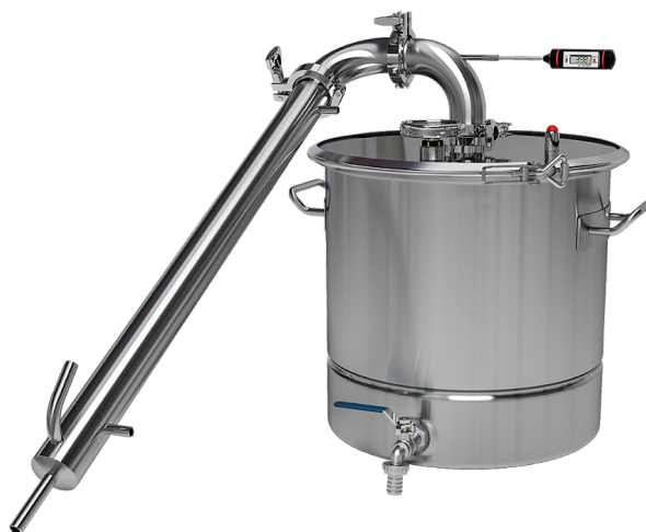
Рис. 5 — Сборка системы в режиме Pot-still
